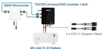
**Hinweis:** Der 1.6kW Controller verfügt über zwei unabhängige MPPT-Eingänge, die jeweils Panneleistungen von 800W bis 900W pro Eingangskanal unterstützen
