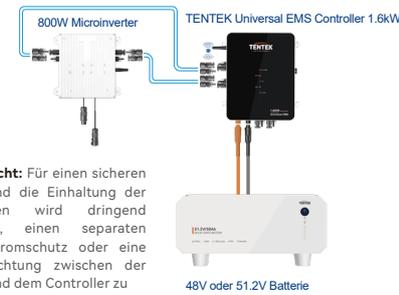
1. **Vorsicht:** Für einen sicheren Betrieb und die Einhaltung der Vorschriften wird dringend empfohlen, einen separaten DC-Überstromschutz oder eine Trennvorrichtung zwischen der Batterie und dem Controller zu installieren.
